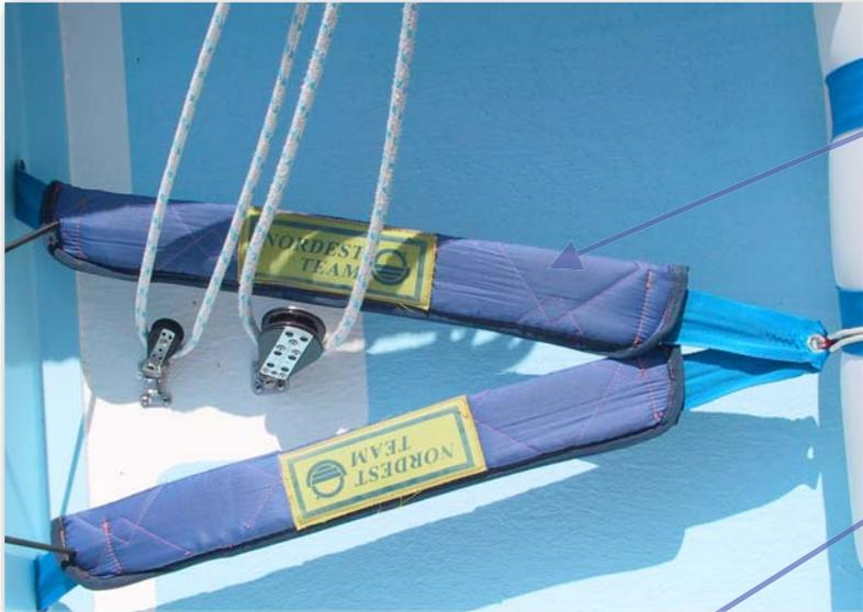
Die Ausreitgurte sollten mit Gummizügen nach oben gespannt werden (So kann der Fuß der Seglerin / des Seglers schnell unter den Gurt gleiten)
