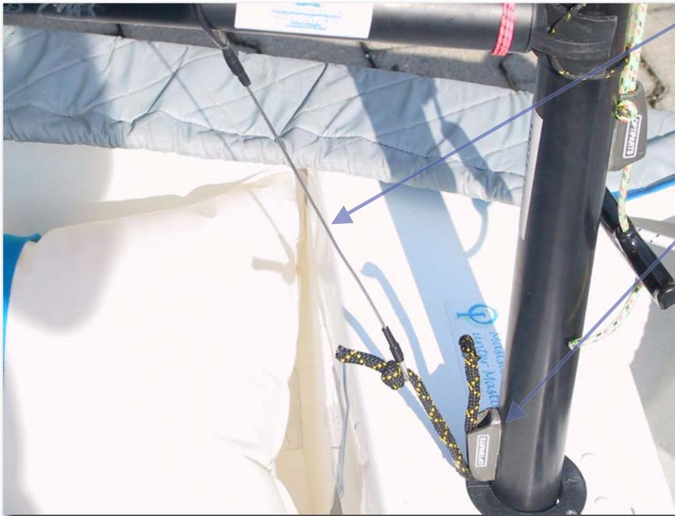
Der Baum des Opti wird mit dem Baumniederholer nach unten gespannt. Dieser verhindert ein Hochsteigen des Segels bei Vorwindkursen und erlaubt in Maßen auch den Trimm des Segels.
