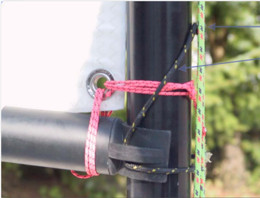
Die richtige Höhe des Baums am Mast wird mit einem Bändsel justiert, das von der Baumgabel über einen
