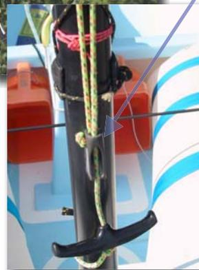
Das Opti-Segel wird mit einer Spriet in seine Form gebracht (Spriettakelung).
