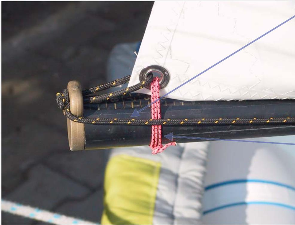
Das Opti-Segel wird wesentlich auch mit dem Unterliekstrecker getrimmt. Der Unterliekstrecker wird vom Baumnock durch die Kausch im Segel, zurück zur Baumnock und dann parallel zum Baum bis zu einer Schlitzklemme geführt.
